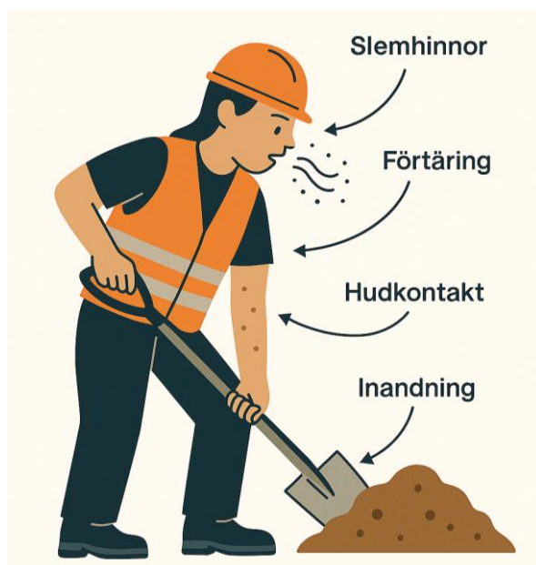
Figur 1 Illustrationen visar hur en person som arbetar med jord kan exponeras för kemiska riskkällor genom inandning av damm eller gaser, hudkontakt med förorenade material, kontakt med ögon eller slemhinnor samt oavsiktlig förtäring. Dessa exponeringsvägar utgör potentiella hälsorisker och bör beaktas vid riskbedömning och planering av arbetsmiljöåtgärder.
